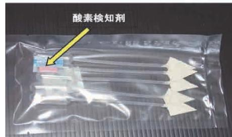
図1. 間隙水採取ピペット
