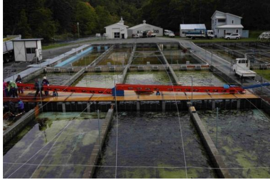
図2 催熟蓄養池。稚魚の飼育池を秋季には催熟蓄養池として使用している。成熟した個体を採卵舎に輸送するためのベルトコンベアーや防鳥網が設置されている。
