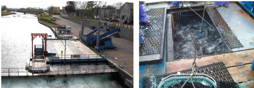
図5 左；千歳川で用いられている捕魚車。画面下側から遡上してきた親魚を水力で動く水車を用いて捕獲する。捕獲した親魚は、木製のデッキ下の魚槽にためられ、活魚輸送車で催熟蓄養池に輸送される。右；魚槽内は右側の図のように高密度の状態となる。
