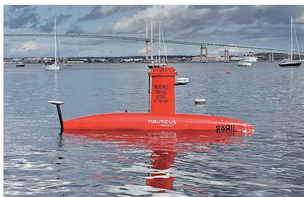
図2. NOAAによる洋上風車周辺の調査に使用されたUSV。仏国Exail社製、Drix。全長約8m、船体下部に吊り下げられたGondolaに各種の音響機器を搭載(参考文献(3)より引用)。
