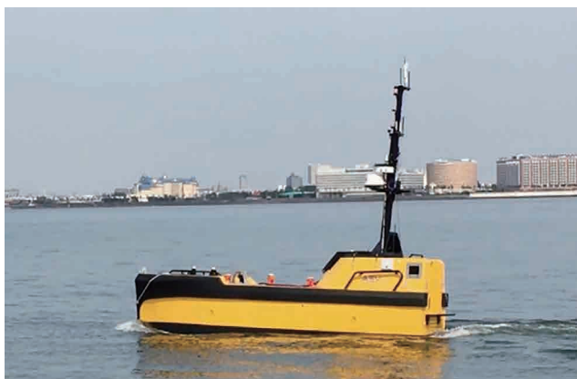
図4. 海上保安庁海洋情報部で運用中のUSV。英国L3Harris社製、C-Worker。全長5.3m、マルチビームソナー等を搭載（参考文献（5）より引用）。
